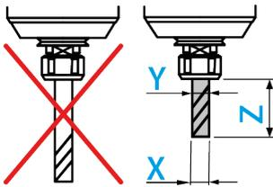
**Der Schneidendurchmesser des Werkzeuges (X) darf nicht größer sein als der maximale Spannereich (Y).**
