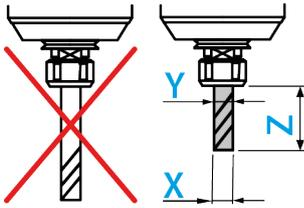
ツールの刃径 (X) は、最大クランプ範囲 (Y) を超えないようにしてください。
