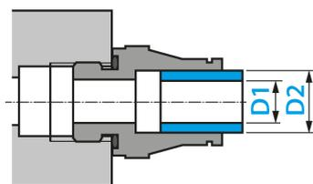
☞ 媒体供給用の接続ラインの定格直径は、以下の表を参照してください：
